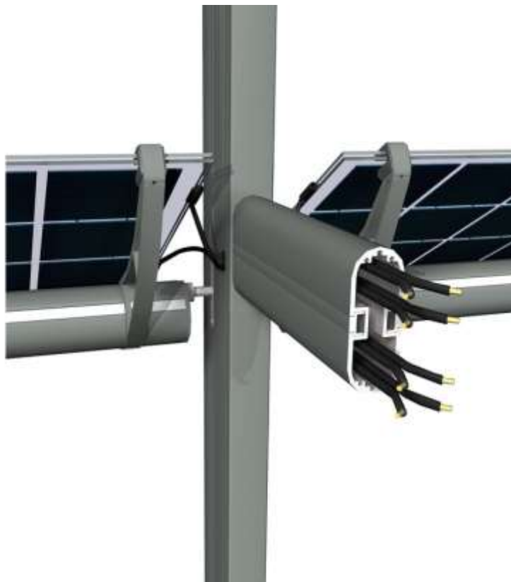
Détail du brise-soleil vertical et du câblage électrique
